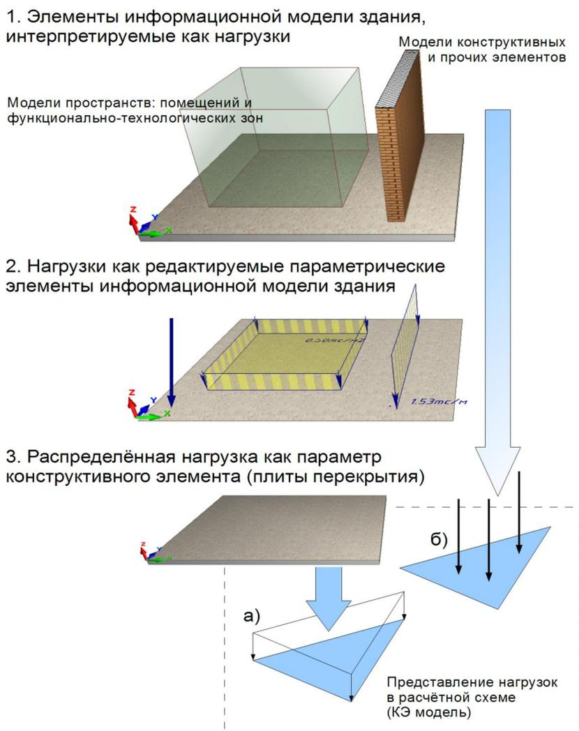
Рис. 2.29. Основные способы информационного моделирования нагрузок
