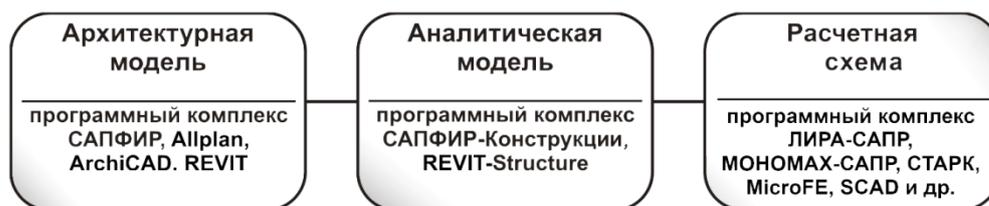
Рис. 2.15. Обобщенная схема преобразования архитектурной модели в расчетную схему
