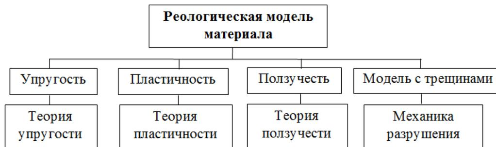
Рис. 6.8. Классификация свойств модели материалов согласно различным теориям
