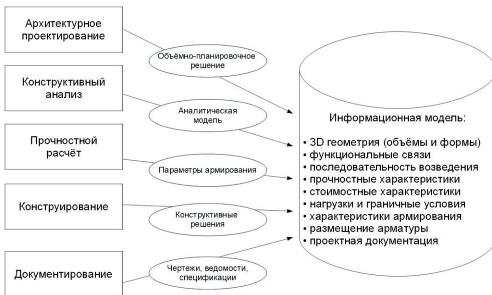
Рис.2.7. Схема функционирования САПР на базе информационной модели
